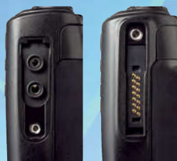
2-poliger Anschluss (links) und 14-poliger Universalanschluss (rechts)
