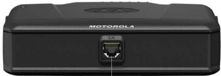
CONNETTORE DEL FRONTALINO DI CONTROLLO RJ50
