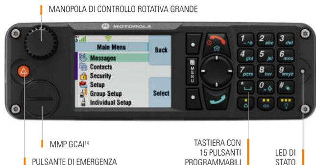
Con il modello di ricetrasmittente a due unità singole remote, i frontalini di controllo remoto possono trovarsi fino a 80 metri l'uno dall'altro.
